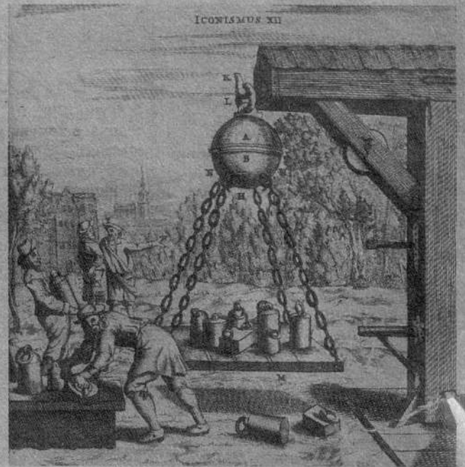
Измерение силы разрежения воздуха Иллюстрация из книги «Новые эксперименты с вакуумом»
